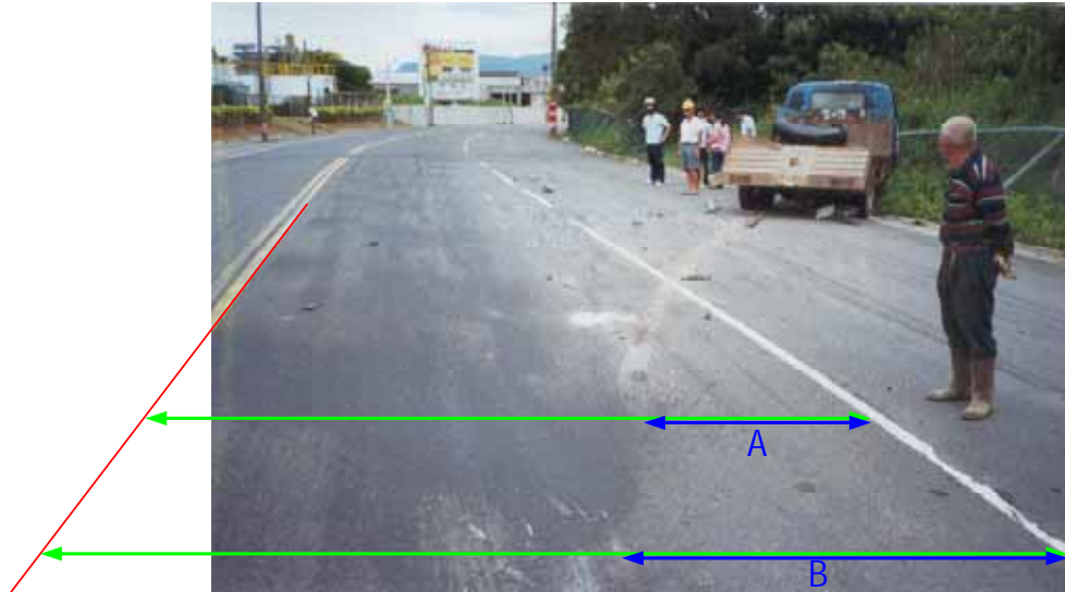
圖4. 事故現場輪胎痕跡起點、刮地痕比例還原重建
