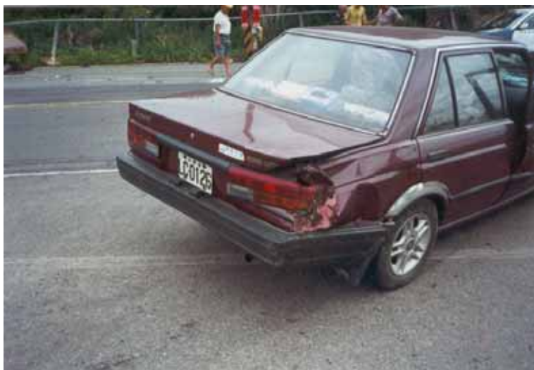
相片3. 甲車右後車角受撞凹損及右後輪前胎痕情形
