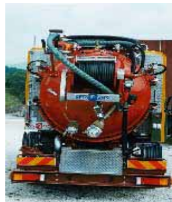
重型車(方型):螢光材料紅色邊框搭配黃色鑽石級或印刷黃紅之鑽石級
