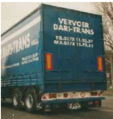
長型車(斜紋):螢光材料紅色搭配黃色鑽石級或印刷黃紅之鑽石級
