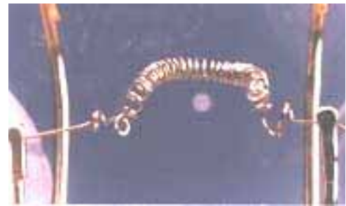
圖四、燈絲「熱震動」變形情形
