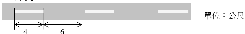
圖 10 小汽車車道分隔線尺寸示意圖
