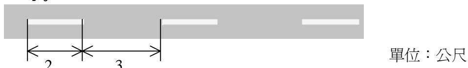
圖 11 機車車道分隔線尺寸示意圖
