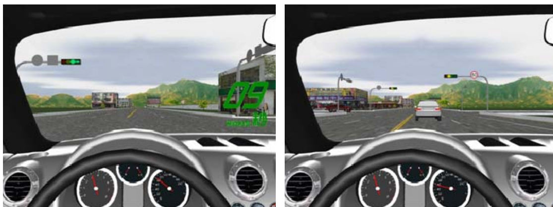
圖 3 (左圖)綠燈倒數計時資訊與(右圖)時相轉換且前車煞車情境
