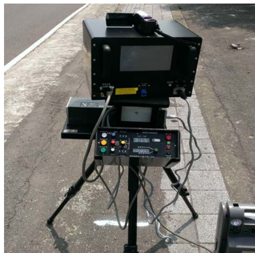
圖 12 移動式雷達測速自動照相設備
