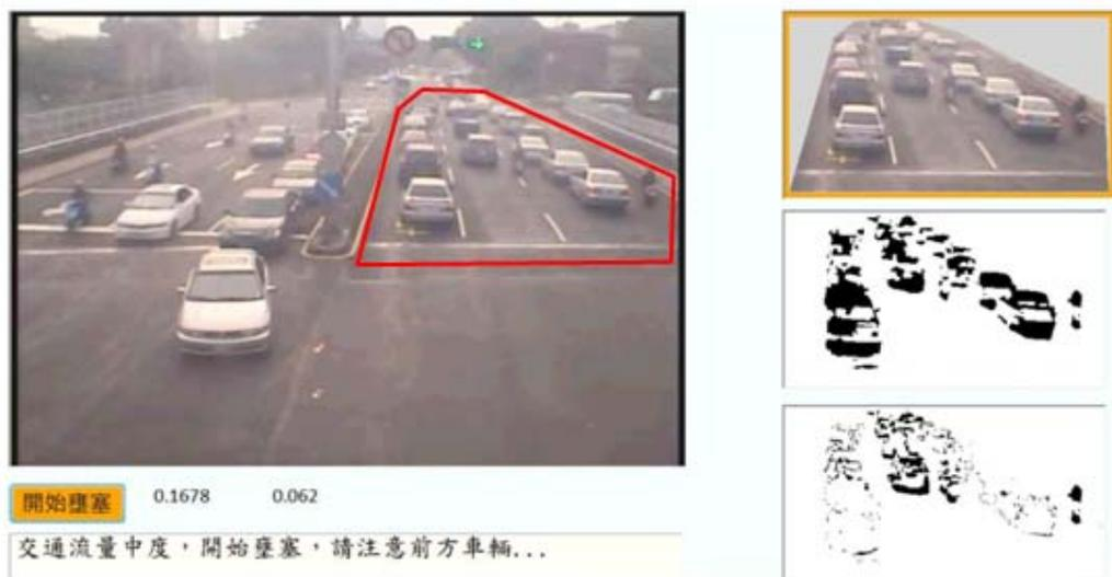
圖 3.3-2 自動監控多邊形，估算車流量並判定壅塞狀況。
