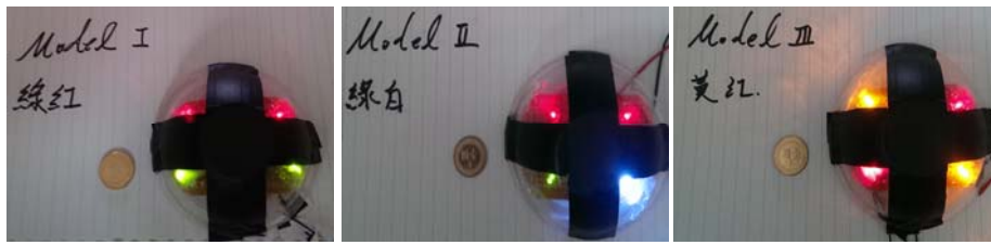
(a) 模組 I 綠紅燈 (b) 模組 II 綠白燈 (c) 模組 III 黃紅燈
