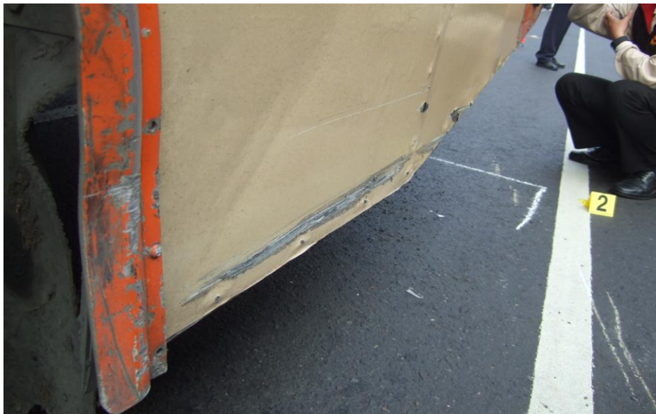
圖2 B車左後車側擦痕顯示：A車在B車左後車角處倒地往左滑行的瞬間即遭C車撞擊
