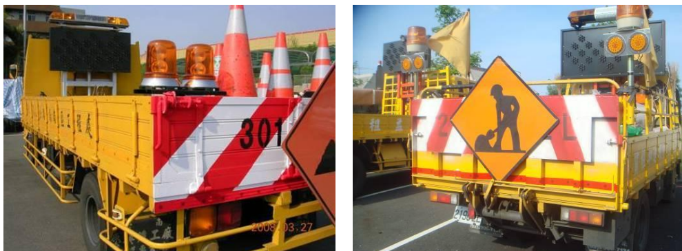
圖 5 高速公路局標誌車應安裝合格車身反光識別標識
