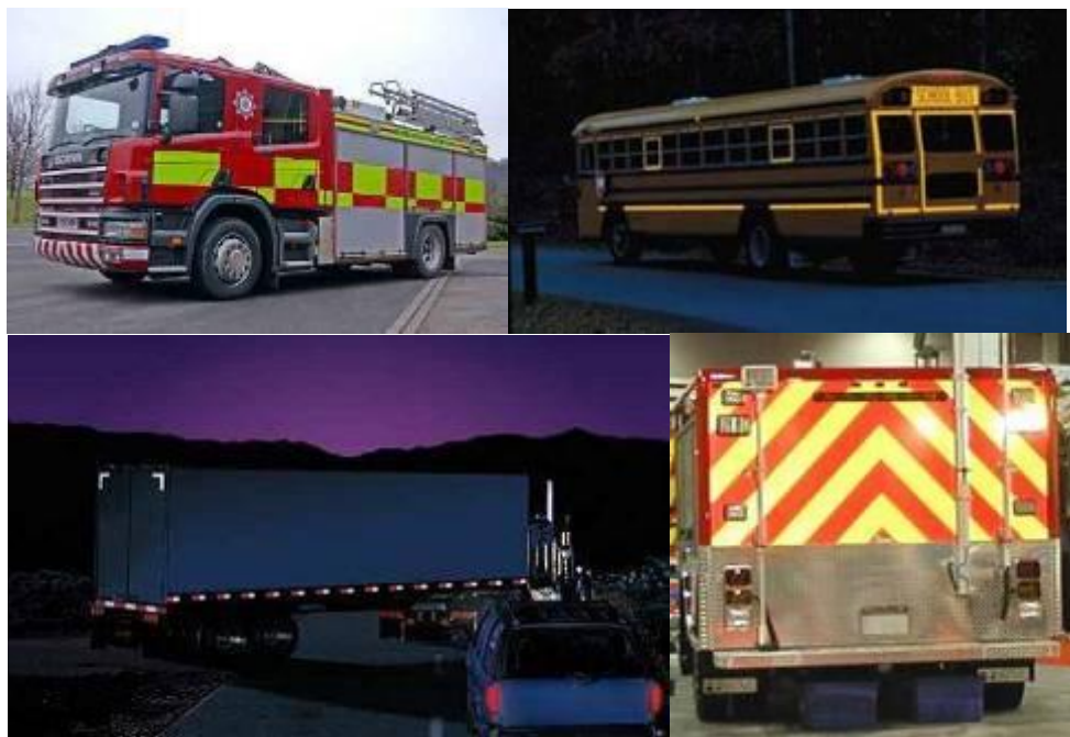
圖 3 美國車身反光識別標識安裝示意圖
