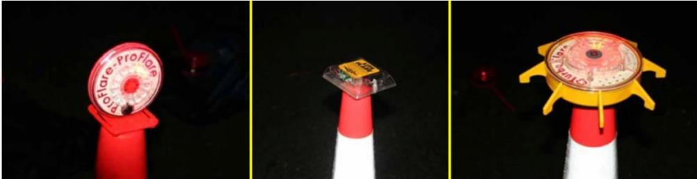
圖 9 電子火炬設於交通錐上方(Mesloh et al., 2008)
