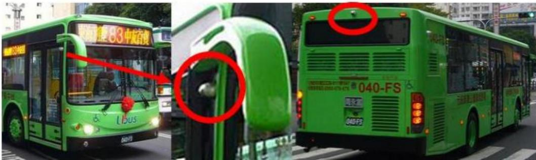
圖 1 行車視野輔助系統裝設示意圖
