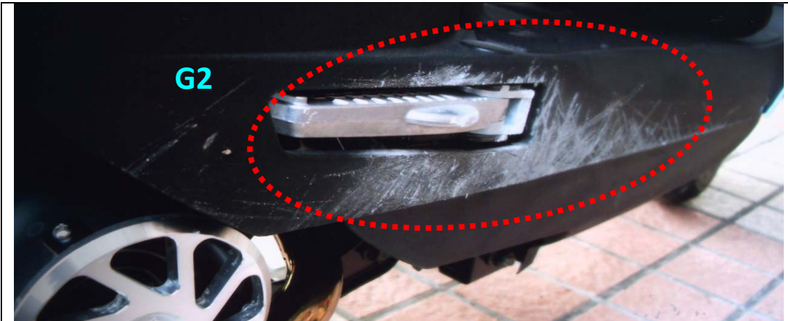
A 車右側車身受損情形
