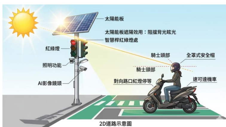
圖 3 路口智慧桿結合太陽能板減少背光示意圖
